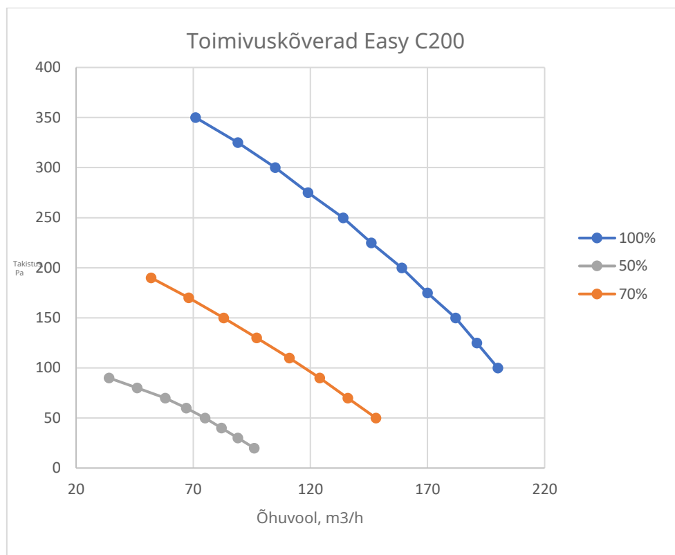
Graafik 3 Ventilatsioonivõimsuse sõltuvus paigaldatud ventilatsioonisüsteemi takistusest
